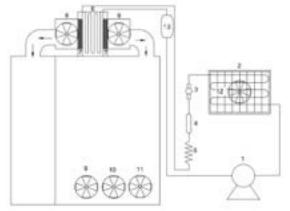
Gambar 1. Skema Sistem Pendingin Ruangan Tekanan Negatif
