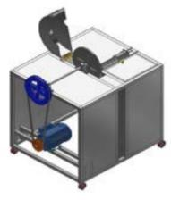
Gambar 2. Disain Mesin Pemotong Tempe
