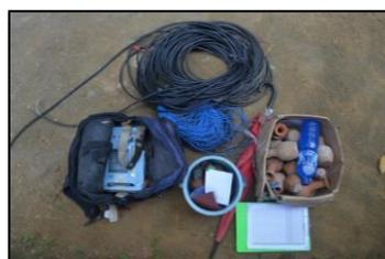
**Gambar 3.** Peralatan dan Perlengkapan Geolistrik IP
